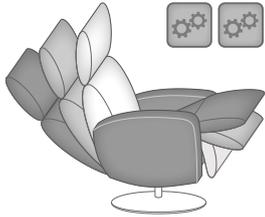
Individuelle Verstellung der Beinauflage und Rückenlehne durch zwei Elektro-Motoren.
