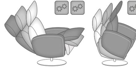
Individuelle Verstellung der Beinauflage und Rückenlehne durch zwei Elektro-Motoren und einem zusätzlichen Elektro-Motor für die Aufstehhilfe (max. 200kg). Mit fixierbarer Drehfunktion bei der bodenfreien Version Bodennahe Version generell ohne Drehfunktion
