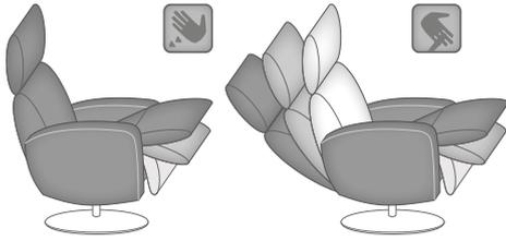
Verstellung der Beinauflage durch Körperdruck. Stufenlose Verstellung der Rückenlehne durch innenliegenden Hebel per Gasdruckfeder und zusätzlichen Körperdruck.
