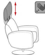
Das Kopfpolster kann durch einfaches Schieben individuell um ca. 6 cm nach oben verschoben werden.
